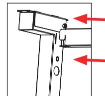
**1.1** Posicione os pés com a travessa central e encaixe a travessa nos recortes laterais dos pés
