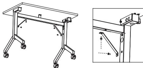
Fixe o suporte no pé e na travessa utilizando o Parafuso M612
