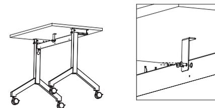
**2.2** Posicione a chapa de apoio e fixe os parafusos M6X12 na travessa
